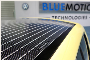
VW E-Up! mit Solardach von Solarion
